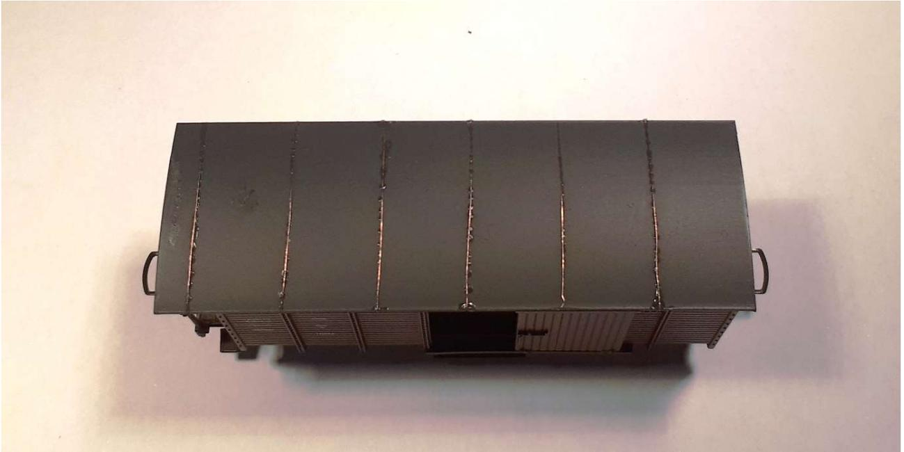
Und damit ist der Umbau auch schon fast fertig - das Dach muss noch lackiert werden. natürlich kann man das Spritzlackieren, aber bei alten Dächern passt auch ein Pinselanstrich sehr gut. Hier zwei Varianten in verschiedenen ‚Alters-Stadien‘.
